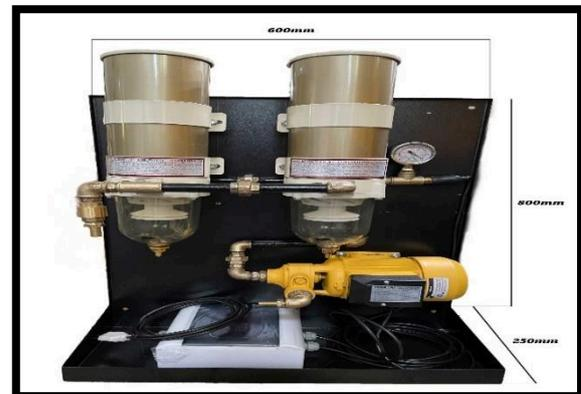
Figura 26: SISTEMA REAL DE RECIRCULAÇÃO DE COMBUSTÍVEL
