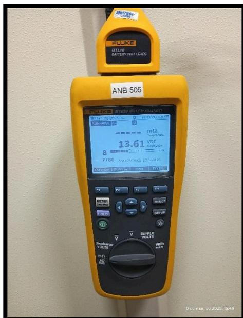
Figura 2: ANALISADOR DE BATERIAS FLUKE BT520
