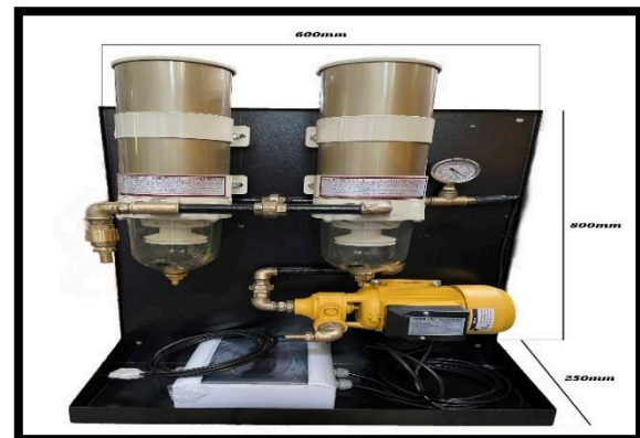
Figura 26: SISTEMA REAL DE RECIRCULAÇÃO DE COMBUSTÍVEL
