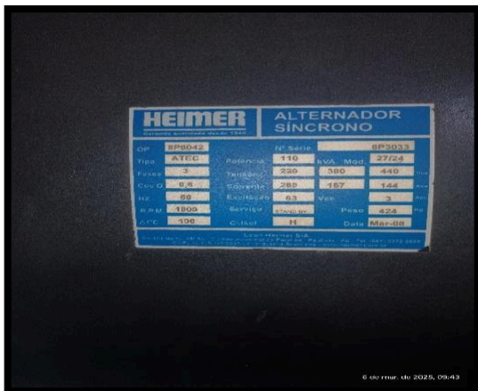
Figura 11: Nº SÉRIE ALTERNADOR - ESPECIFICAÇÕES
