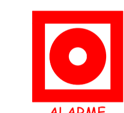
DETALHE - SINALIZAÇÃO DO ACIONAMENTO DO ALARME DE INCÊNDIO SEM ESCALA
